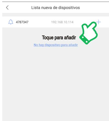
En caso de que el intercomunicador no aparezca automáticamente, seleccione el icono **+** (lado derecho superior), después la opción **Añadir nuevo dispositivo** y, por último, **Conexión por cable**.
